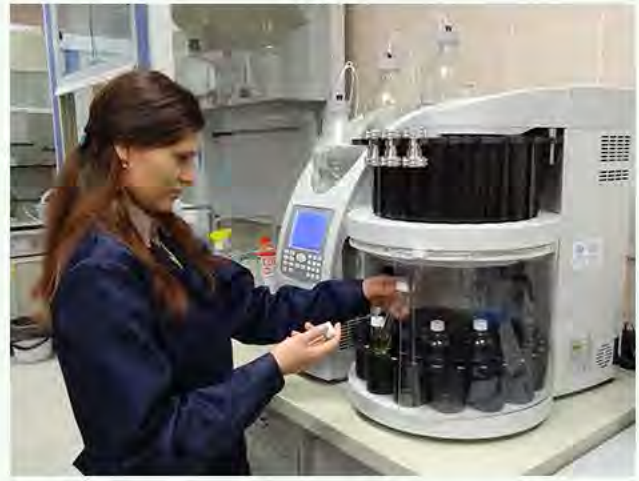
Высокоэффективная экстракция органических соединений из твердых объектов на экстракторе ASE-350
